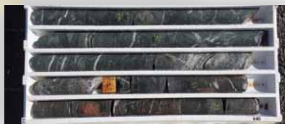
Slika 2 - Vzorec vrtine MVPDH001 prikazuje variabilno intenzivnost kremenovega karbonata, žil in jeder sericitnega klorita.
