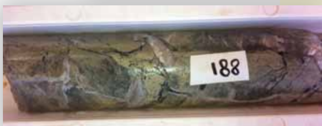
Slika 2 - Vzorec vrtine MVPDH001 prikazuje variabilno intenzivnost kremenovega karbonata, žil in jeder sericitnega klorita.
